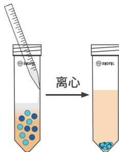
用磷酸盐缓冲液(PBS)洗涤收集到的PBMCs,在 $250\times g$ 离心力下室温离心10min。
