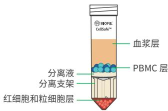
放入离心机,室温下离心10min,离心力为 $1200\times g$ ,无需关闭刹车(离心后液体分层从上到下分别为:血浆层、PBMC层、分离液、分离支架以及红细胞和粒细胞层)。
